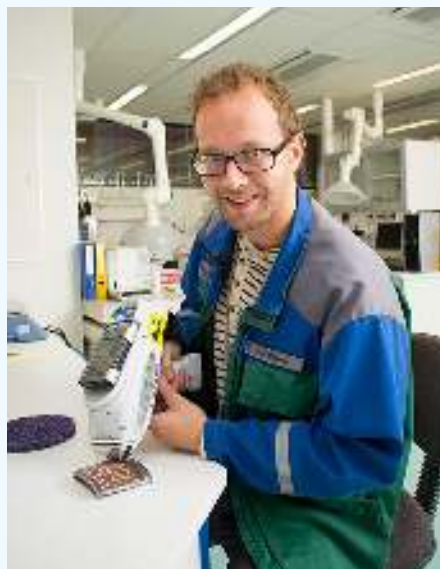
📍 Kemian insinööri Joni Niiranen tutkii XRF-analysaattorilla materiaalien metallipitoisuuksia. Jos kappale sisältää ei-hyväksyttyä ainetta, se korvataan tai vaihdetaan toiseen materiaaliin.
