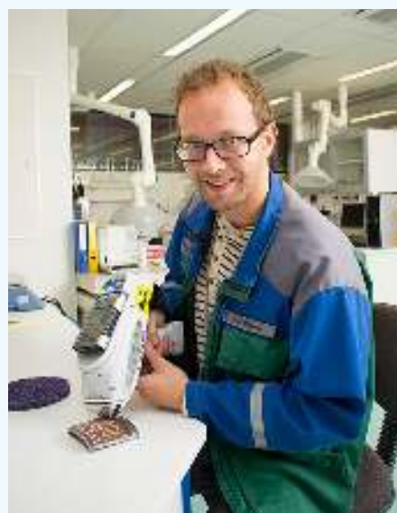
Kemiingenjör Joni Niiranen undersöker metallinnehållet med en XRF-analysator. Om det undersökta objektet innehåller oönskade ämnen byts det ut.
